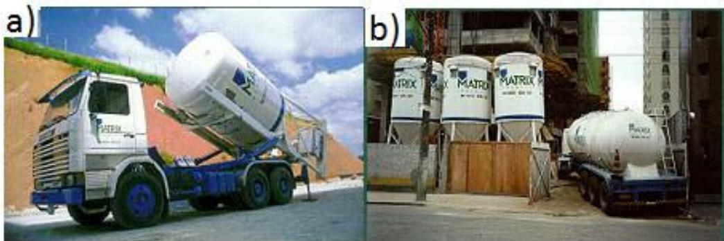
Ilustração 77: a) transporte do silo por caminhão. b) Caminhão graneleiro para reabastecer silo do sistema de "via seca". Fonte: [53]
