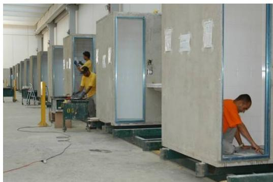
Ilustração 26: Produção do banheiro pronto. Fonte: <http://www.banheiropronto.com.br/> Repartição dos tempos e tarefas na construção.
