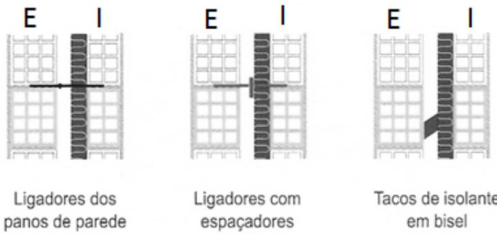
Ilustração 138: Métodos para auxiliar a fixação dos isolamentos rígidos, sendo E o pano exterior e I o pano interior. Fonte: [10]
