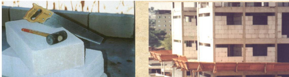
Ilustração 67: Blocos de concreto celular autoclavado. Fonte: [33].
