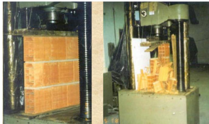
Ilustração 95: Resistência a compressão de alvenaria. Fonte: [33]
