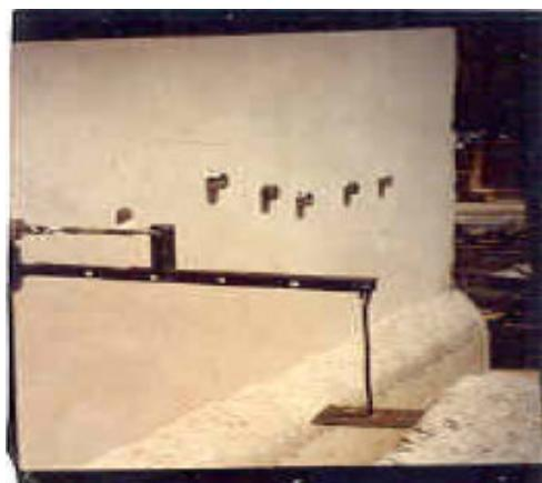
Ilustração 81: Resistência de aderência. Fonte: [49]
