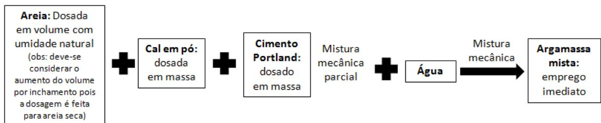
Ilustração 84 Esquema da produção de argamassa mista dosada em obra sem o preparo da argamassa intermediária. Fonte: [53]
