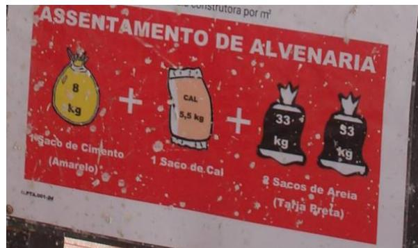
Ilustração 157: Dosagem da argamassa de acordo com quantidade de sacos de cores e constituintes diferentes.
