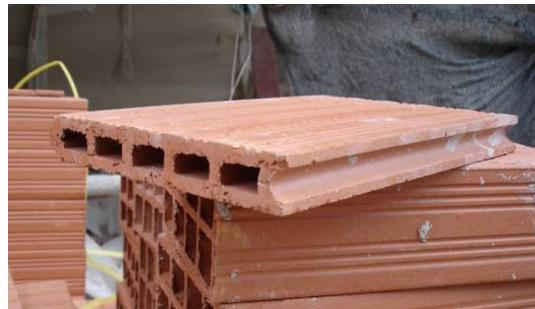
Ilustração 132: Tijolo utilizado na forra. (Foto: Mercia Barros)
